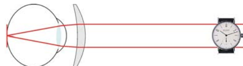
Korrigiertes Weitsichtiges Auge: Durch Brille (oder Kontaktlinsen) werden die Lichtstrahlen aus der Ferne auf der Netzhaut abgebildet (deutliches Bild)
